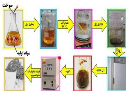
شکل 1. فرآیند تهیه نانوذرات فریت اسپینلی استرانسیوم.
