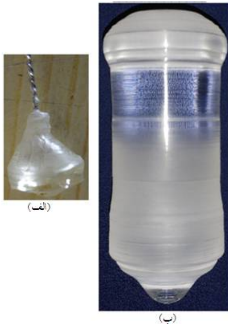
شکل 13. دو تصویر از بلور BGO رشد یافته توسط سامانه مورد مطالعه با ارتفاع (الف) 1cm و (ب) 5cm.
