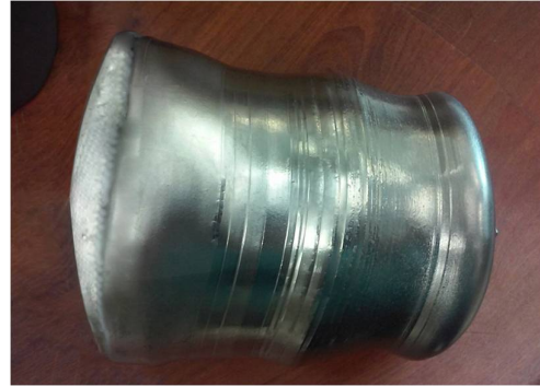
شکل 6. بلور ژرمانیوم رشد داده شده به ارتفاع 9 سانتی‌متر و قطر 7 سانتی‌متر به روش چکرالسکی.
