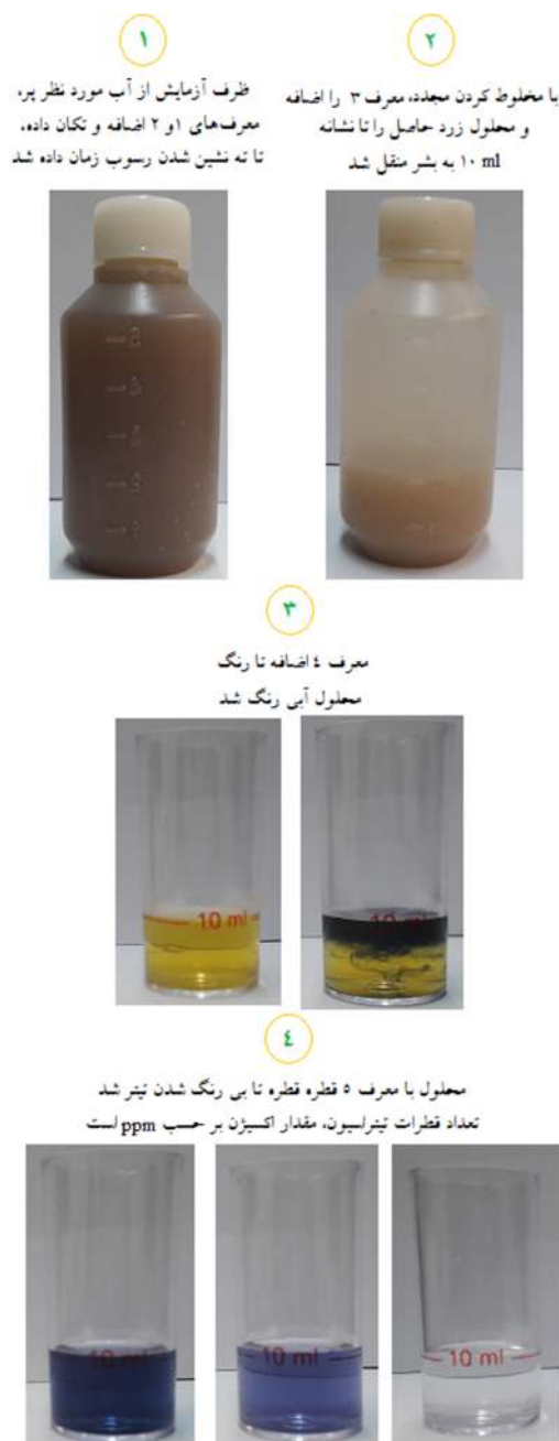
شکل ۲. مراحل اندازه‌گیری اکسیژن محلول در آب با استفاده از کیت آنالیز آب.
