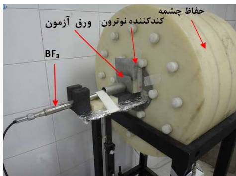
شکل ۵. چیدمان اجزای آزمایش به منظور اندازه‌گیری شار عبوری از جاذب‌های مختلف.
